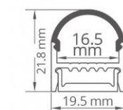
**Profilé pour bandeau LED, en aluminium.** Diffuseur givré arrondi. 21,8 mm x 19,5 mm - Possibilité d'installer un ruban jusqu'à 16,5 mm de largeur.
