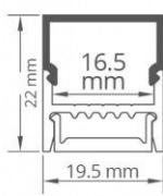
**Profilé en applique pour ruban LED.** Aluminium avec finition anodisée. 22 mm x 19,5 mm - Intégration d'un ruban LED ne dépassant pas 16 mm de large.
