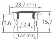
**Profilé à encastrer pour bandeau LED.** Aluminium, finition anodisée. 23,7 mm x 15,7 mm – Adapté aux rubans de 12 mm de largeur maximum.
