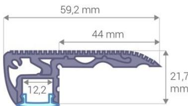
**Profilé nez de marche d'escalier pour ruban LED.** En aluminium. 59.2 mm x 21.7 mm - Compatible avec bandeau LED de 12mm de large max.
