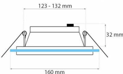
**Spot LED en verre encastrable 12 watts.** Downlight décoratif. Angle de diffusion 150° - Indice de protection IP44 - 230 V fourni.
