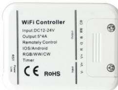
Ce **contrôleur WIFI universel à 5 voies** va vous permettre de contrôler directement vos rubans LED et spots LED à partir de votre **smartphone ou tablette** en liaison radio.
